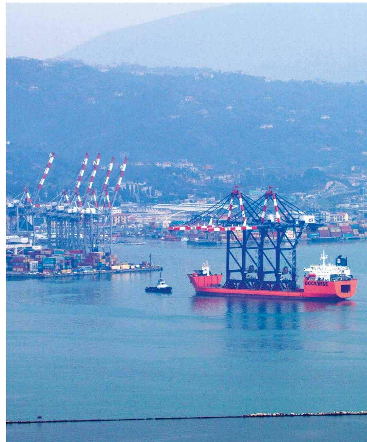
Schiffsgrößenentwicklung: Der La Spezia Container Terminal erhielt am 24. März 2015 zwei neue Containerbrücken aus Shanghai, die 23 Containerreihen an Deck eines Schiffes abfertigen können.
